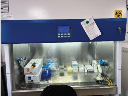
هود للتعامل مع الخلايا البشرية (Laminar flow hood)
