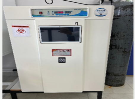
حاوية ثاني أكسيد الكربون (CO2) (CO 2 incubator)
