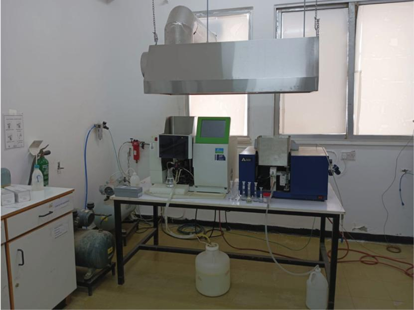
يستخدم جهاز امتصاص الطيف الذري في قياس تراكيز مختلف المعادن (لا سيما المعادن الثقيلة والسامة منها مثل الرصاص والكاديوم والزرنيخ والنحاس والنيكل وغيرها) وذلك من خلال قياس مقدار الامتصاص الخاص بالعنصر المراد قياسه وذلك عند طول موجي محدد يتواجد ضمن الطيف المرئي وال فوق بنفسجي من الطيف الكهرومغناطيسي. يعتمد مبدأ عمل الجهاز على قانون بير المتعلق بامتصاص الضوء من قبل مختلف المواد في الطبيعة...
