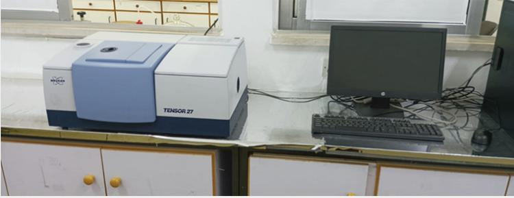
يستخدم جهاز مطيافية الأشعة الحمراء باستخدام تحويل فورييه في قياس طيف امتصاص الأشعة تحت الحمراء لمختلف المركبات الكيميائية العضوية وغير العضوية. يعتمد الجهاز في عمله على الأنماط الاهتزازية للروابط الكيميائية في مختلف المركبات الكيميائية. طيف امتصاص الأشعة تحت الحمراء الناتج يغطي أطوالاً موجية مداها من
