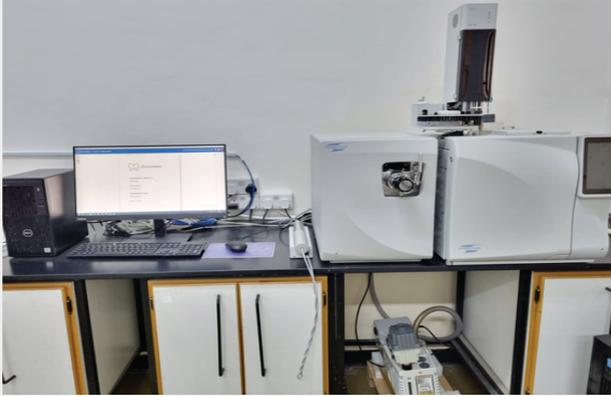
هي تقنية فصل تحليلية تنطبق على عينات الغاز والسائل والصلبة (المكونات التي تتبخر بالحرارة). يجمع بين أداتين تحليليتين لتحديد المركبات وقياس تركيز المواد الكيميائية الموجودة في الأغذية والزيت، والأدوية والبيئة وغيرها.
