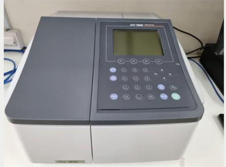
هي تقنية تحليلية تقيس كمية الضوء الذي يمتصه المحلول الموجود في cuvette داخل الجهاز.
